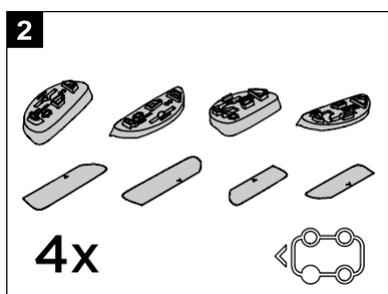
使用腳墊（6-9）上的圖示協助識別在車輛上的適當位置，然後將耐磨膠帶（13-16）對齊腳墊（6-9）。
