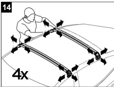
用力向各個方向拉動，測試前、後橫梁是否安裝牢固。
