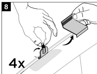
取下夾鉗工具 (1)，並確定固定夾 (12) 嵌入玻璃下方的金屬承受端。上拉並擺動以確定正確嵌入。確定鉤子的中央對齊箭頭。
