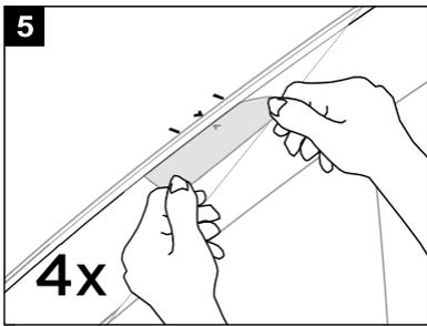
將玻璃上的箭頭對齊耐磨膠帶 (13) 上的箭頭，然後將 (13) 耐磨膠帶貼到車輛的前駕駛側，同時將膠帶的邊緣對準裝飾線的邊緣。
