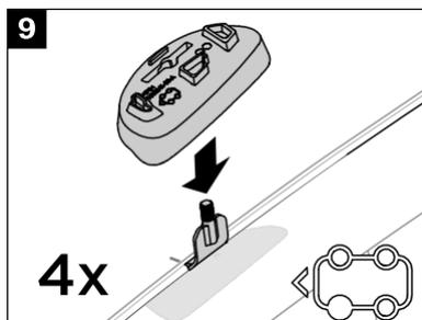
將前駕駛側腳墊 (6) 放置在前駕駛側的固定夾上。使用圖示來協助識別以及將正確的腳墊 (6-9) 安裝到正確的位置。
