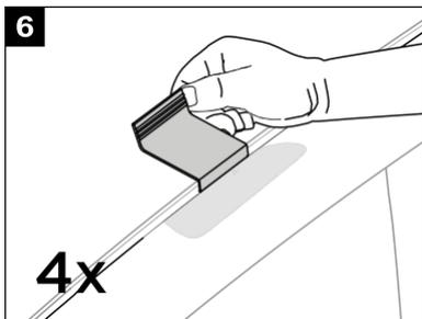
使用夾鉗工具 (1)，在箭頭位置小心縮回橡膠墊片。
