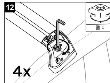
使用六角扳手（2）擰緊螺帽，直到基座牢牢貼附車輛為止。建議擰緊至 2.5-3.5 Nm。若要確認基座是否正確完成安裝，請向所有方向拉動以確定沒有任何移動。為了鎖定系統，基座上的標記必須對齊蝶形螺帽上的標記（請參閱圖 1）。
