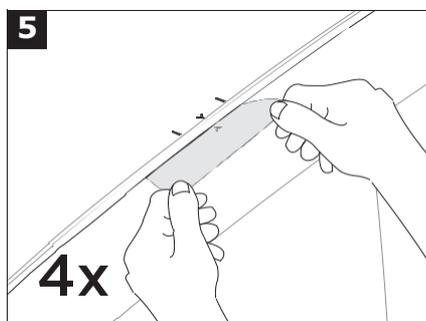
ガラスにある矢印を耐摩耗テープ(12)の矢印に合わせ、テープの端をトリムラインの端に合わせて、耐摩耗テープ(12)を車両の運転席側前方に貼り付けます。
