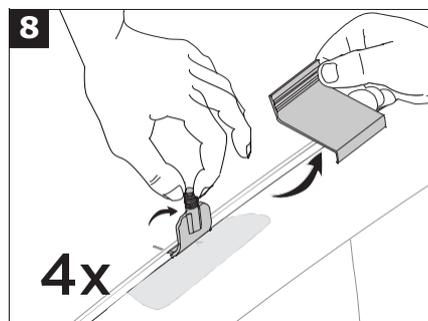
クリップ ツール(1)を取り外し、クリップ(11)がガラス下の金属レシーバーに固定されていることを確認します。引き上げたり少し揺らしたりして正しく固定されていることを確認します。フックの中心が矢印と合っていることを確認します。
