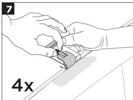
クリップ ツールを所定の位置に保ち、矢印の位置にクリップ(11)を差し込みます。
