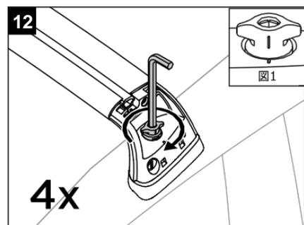
タワーが車両にしっかりと固定されるまで、六角レンチ（2）でウイング ナットを締めます。（締付けトルク：8.0 + / - 1.0 Nm を推奨）すべての方向に引いて動きや、ガタつきがないことを確認し、タワーが正しく取り付けられていることを確かめます。システムをロックするには、ウイング ナットのマークがタワーのマークと一致している必要があります。（図1を参照）
