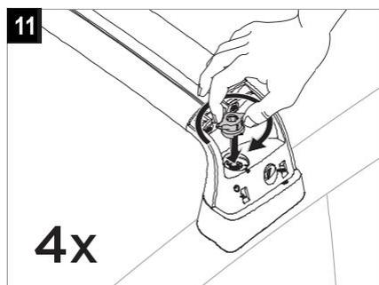
各タワーにウイング ナット（10）を取り付け、手で仮止めします。
