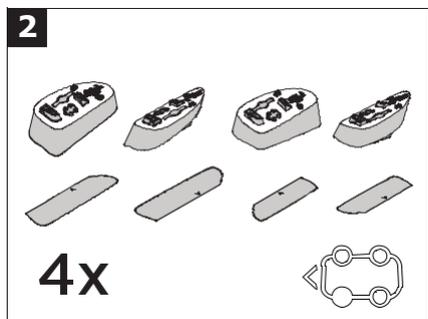
フットパッド(5-8)にあるアイコンを参考に車両上の適切な位置を特定し、耐摩耗テープ(12-15)をフットパッド(5-8)に合わせます。
