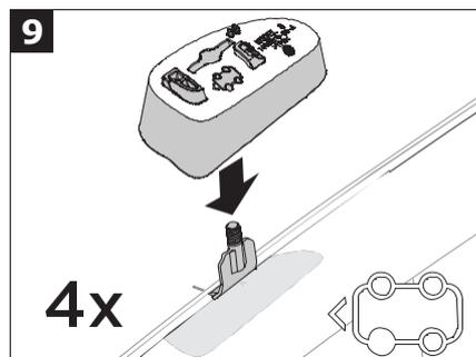
運転席側フロント パッド(5)を運転席側フロントクリップの上に置きます。図のアイコンを参考に正しいパッド(5～8)を特定し、適切な場所に取り付けます。
