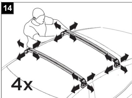
すべての方向に強く引き、フロントとリアのクロスバーがしっかりと取り付けられていることを確認します。
