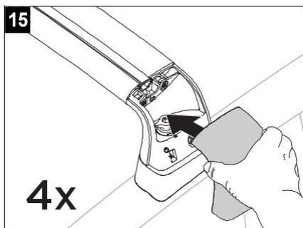
カバーを取り付けます。下部のツメを合わせてから、上部を所定の位置に押し込みます。
