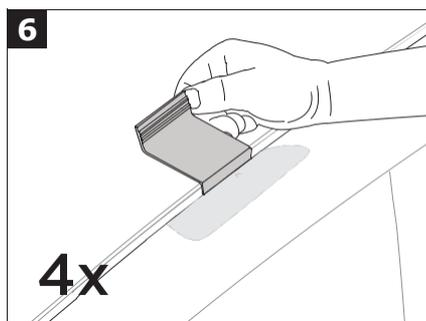
クリップ ツール(1)を使用し、矢印の位置にあるゴム製ガスケットを慎重にめくります。
