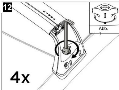
Dann die Flügelmuttern mit dem Sechskantschlüssel (2) festziehen, bis der Standfuß der Querstrebe sicher am Fahrzeug befestigt ist. Wir empfehlen einen Anzugsmoment von 2,5 - 3,5 Nm. Um den Standfuß auf sichere Befestigung zu prüfen, ihn in alle Richtungen ziehen und sicherstellen, dass er sich nicht bewegt. Um das System verriegeln zu können, muss die Markierung an der Flügelmutter mit der Markierung am Standfuß ausgerichtet sein (siehe Abb. 1).
