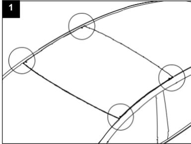
Das Dach des Fahrzeugs an den Pfeilpositionen auf dem Glas gründlich reinigen.
