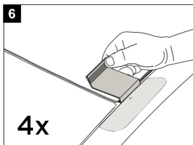
Mit dem Clipwerkzeug (1) die Gummidichtung vorsichtig an der Pfeilposition einpassen.
