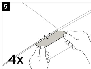
Das Abriebschutzband (13) auf der Fahrerseite vorne am Fahrzeug anbringen. Dazu den Pfeil auf der Glasscheibe mit dem Pfeil auf dem Abriebschutzband (13) und die Bandkante mit der Kante der Verkleidung ausrichten.
