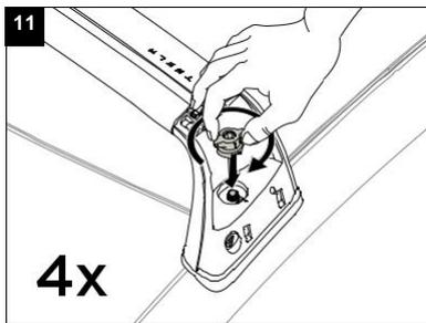
Die Flügelmutter (11) von Hand an jedem Standfuß der Querstreben anschrauben und fingerfest anziehen.
