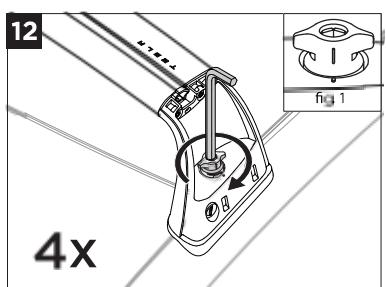
타워가 차량에 단단히 부착될 때까지 육각 렌치 (2)로 윙너트를 조이십시오. 2.5-3.5Nm으로 조이 것을 권장합니다. 타워가 올바르게 설치되었는지 확인하려면 모든 방향으로 당겨보고 이동이 없는지 확인하십시오. 이 장치를 잠그기 위해서는 윙너트의 마크를 타워의 마크 (그림 참조)와 맞춰야 합니다.
