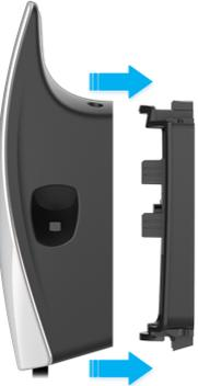
2. Fixez l'unité principale au boîtier de câblage à l'aide des quatre attaches incluses et de l'embout hexagonal de 4 mm inclus avec un tournevis. Appliquez toujours une bonne pression sur la façade pour compresser le joint interne. Serrez les quatre attaches à la main jusqu'à ce qu'elles soient bien fixées.
