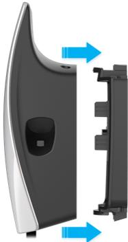
2. Fije la unidad principal a la caja de cables con las cuatro fijaciones y la punta hexagonal de 4 mm que vienen incluidos usando un destornillador de punta intercambiable y aplicando suficiente presión a la placa frontal durante el proceso para comprimir el sello interno. Apriete firmemente a mano las cuatro fijaciones hasta que queden seguras.
