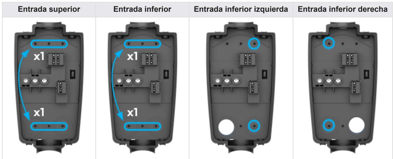
2. Coloque la caja de cables en las ubicaciones de montaje usando la punta hexagonal de 4 mm y los dos tornillos de sujeción para madera que vienen incluidos.
