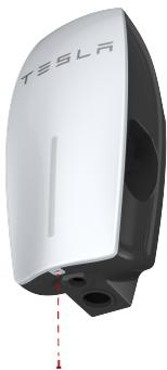
2. 用 T20 安全针脚梅花螺丝刀拆下密封盖板上的六颗螺钉。慢慢拆下密封盖板，断开带状电缆连接。保管好螺钉和盖板，以便组装时使用。
