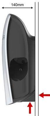
1. 将薄型支架作为参照，在墙上标记出螺钉的安装位置。
