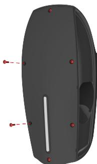
**⚠ Cuidado:** Não deixe a tampa estanque pendurada no cabo de fita. Isto pode danificar o cabo de fita ou os respetivos conetores.
