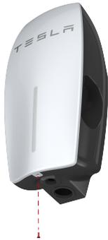
2. Utilisez une clé Torx de sécurité T20 pour retirer les six vis sur le couvercle d'étanchéité. Déposez soigneusement le couvercle d'étanchéité et déconnectez le câble plat. Gardez les vis et le couvercle pour le remontage.
