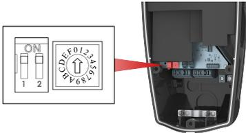
**⚠ Avertissement :** L'alimentation **DOIT** demeurer **COUPÉE** avant le réglage ou la modification du réglage des commutateurs DIP ou rotatif. La modification du réglage de ces commutateurs avec l'alimentation **ACTIVÉE** ne sera pas reconnue par le système et est dangereuse en raison des risques de chocs électriques.
