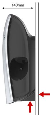
1. Utilisez le support plat comme guide pour marquer l'emplacement au mur des vis de montage.
