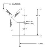
Avertissement : La colonne inutilisée (L3 sur l'illustration) doit rester ouverte. Ne la raccordez pas à la barre neutre ou à la mise à la terre.
