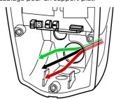
3. Dénudez les câbles de branchement allant vers la plaque à bornes sur le support pour entrée par le haut sur 18 mm (3/4 po). L'utilisation de bagues est recommandée.
