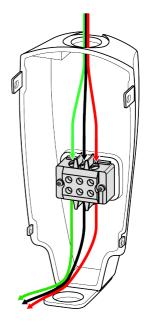
L'illustration suivante montre un exemple de câblage pour un support plat.
