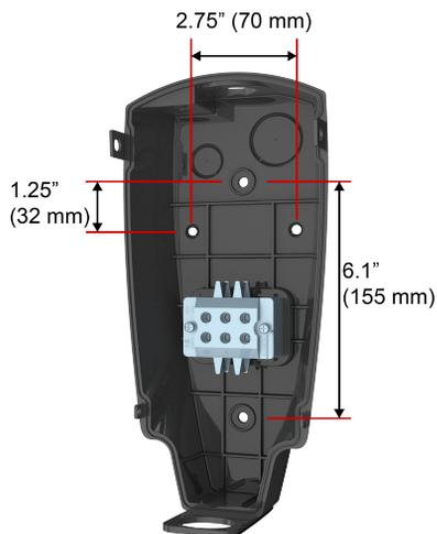
3. Monte el soporte con fijadores que sean adecuados para el material de la pared en que se va a instalar, taladrando orificios guía si es necesario. Utilice los tornillos que se suministran sólo si instala el soporte sobre una superficie de madera. Si el montaje se hace en otro tipo de pared (hueca, mampostería, etc.), use fijadores que sean lo suficientemente largos para anclar firmemente el conector de pared y que puedan soportar por lo menos 80 lb (36 kg).
