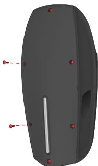
**⚠ Precaución:** No deje la cubierta de sellado colgando del cable plano. Si lo hace, se puede dañar el cable plano o los conectores.
