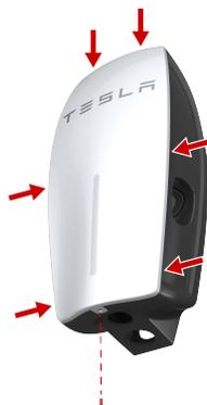
3. Use un destornillador Torx T10 para instalar el tornillo que fija la parte inferior de la cubierta exterior a la cubierta. Apriete el tornillo a 4.4 in-lb (0.5 N-m).
