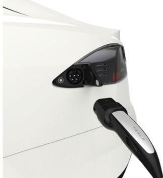
5. Una volta collegato il connettore portatile al veicolo, la luce accanto alla presa per la ricarica lampeggia in verde e il quadro strumenti visualizza informazioni sulla ricarica. La luce si spegne subito dopo aver bloccato il veicolo.
