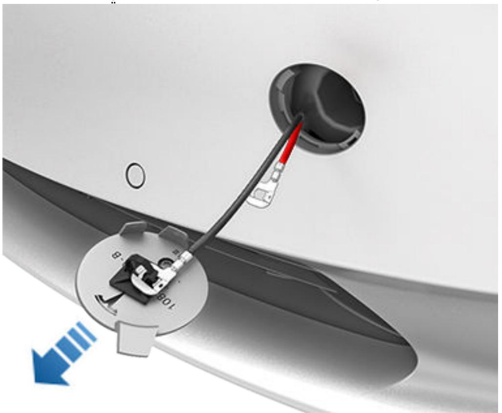
قم بتوصيل الكبل الأحمر الموجب (+) من مصدر الطاقة الخارجي بجهد ٢٤ فولت بالطرف الأحمر الموجب (+) في جانب السيارة.
