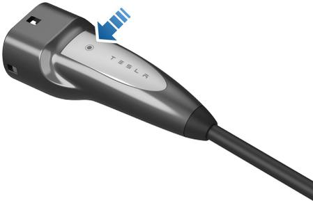
**REMARQUE :** Votre véhicule est déverrouillé lorsque la clé est à proximité et que le déverrouillage automatique est activé. Vous pouvez également ouvrir la trappe de la prise de recharge à l'aide de l'une de ces méthodes :
