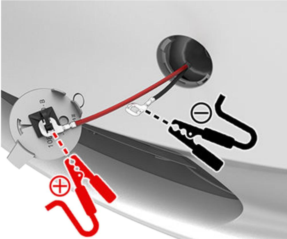
6. Encienda la fuente de alimentación externa (consulte las instrucciones del fabricante de la fuente de alimentación externa). Los cierres del capó se desbloquean inmediatamente y ahora puede abrir el capó para acceder a la zona del maletero delantero.
