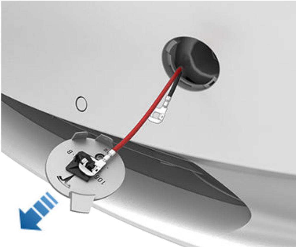
4. Conecte el cable rojo positivo (+) de la fuente de alimentación externa de 12 voltios al terminal rojo positivo (+) del lado del vehículo.
