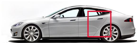
**PASSAGGIO 2:** Utilizzare una sega circolare da 30 cm per eseguire un taglio di 152 mm attraverso l'etichetta e nel montante.
